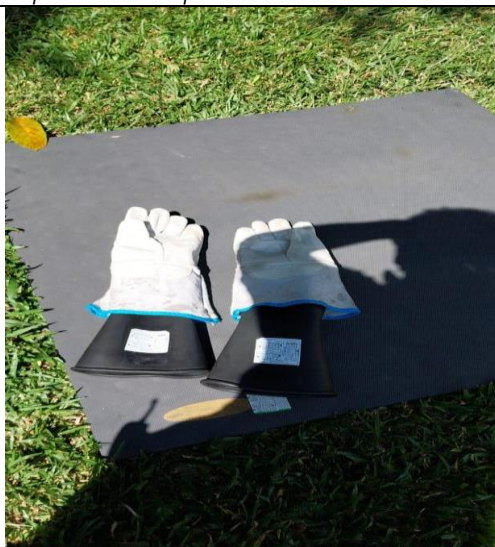
FOTO 76: Manutenção anual periódica dos equipamentos de proteção individual e coletiva da entrada de energia elétrica.
